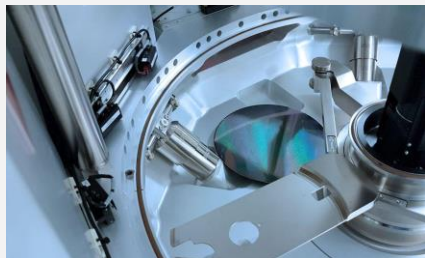
Endura PVD chamber 設備外異常偵測
