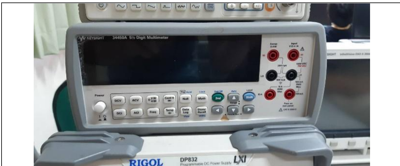
桌上型三用電錶（型號：Keysight 34450A）
