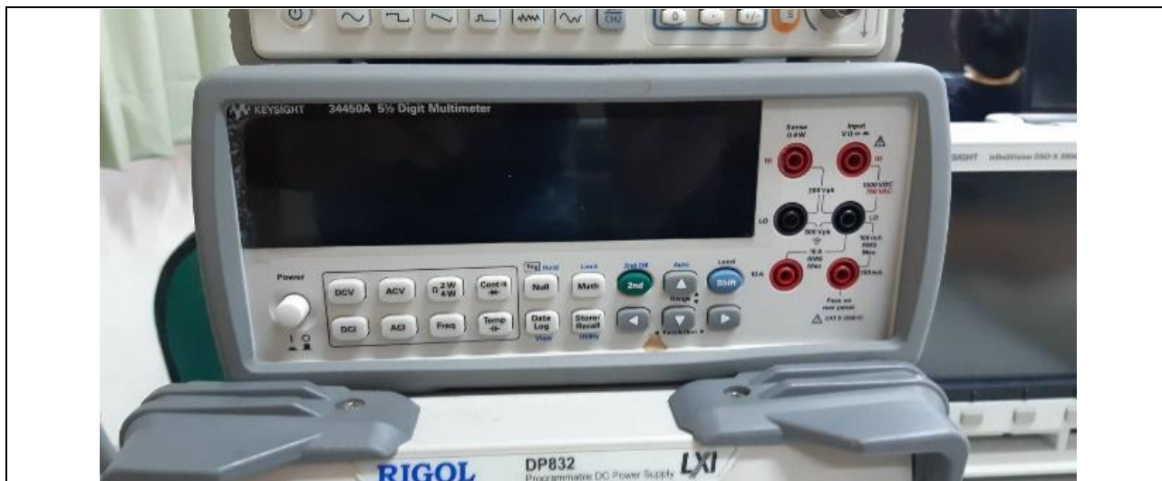
桌上型三用電錶（型號：Keysight 34450A）
